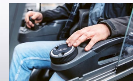
Eine von zwei Steuerungsoptionen: das Mini-Wheel
